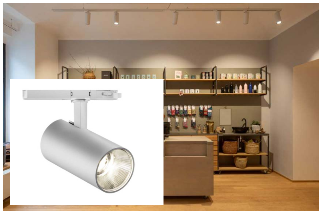
typ B – vstupní hala, chodby, družiny - akcentovací svítidlo do 3fázové lišty, LED, vyzařovací úhel 32°/52°, 1880 lm, CRI>90, životnost L90/B50 60 000 hodin, barva černá (std. U1 lighting)
