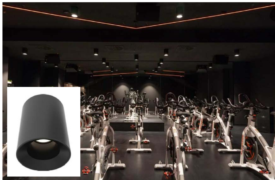
typ A – vstupní hala a chodby bez podhledu - přisazené svítidlo, LED, CRI80, 2000lm, vyzařovací úhel 60°, UGR<19, SDCM: 3, barva černá (std. U1 lighting)
